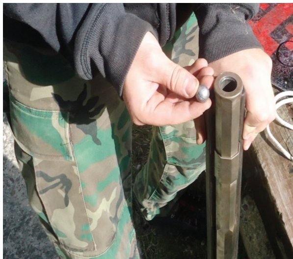
Obrázok č. 6. Systém nabíjania: Vloženie projektilu do hlavne. Fotografia: autor.
