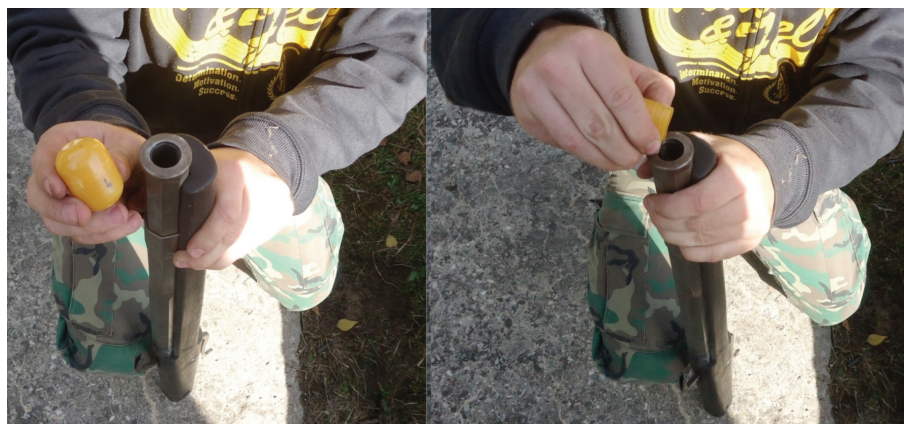
Obrázok č. 3. Systém nabíjania: Vysypanie strelného prachu do hlavne. Fotografia: autor.
