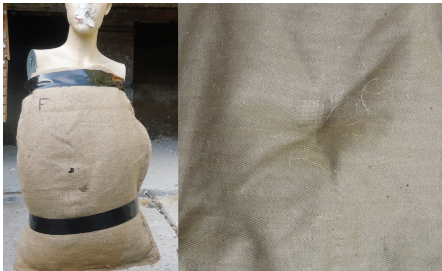
Obrázok č. 16. Strel'ba č. 19: projektil pri 6 g síce prešiel cez vrstvu vrecoviny, no neprešiel cez prešívany kabátec (hrubý 49 mm). Fotografia: autor.
