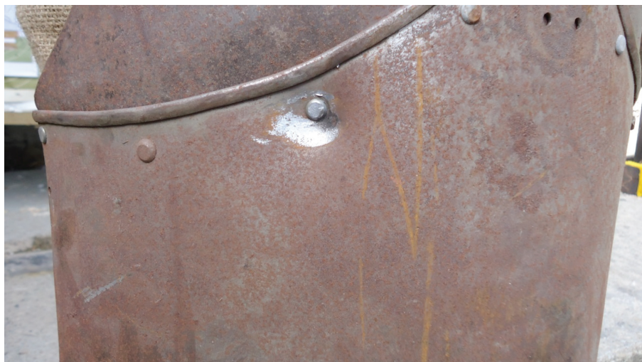
Obrázok č. 15. Strelba č. 17, detail po odraze projektilu od kyrysu pri 6 g strelného prachu. Fotografia: autor.
