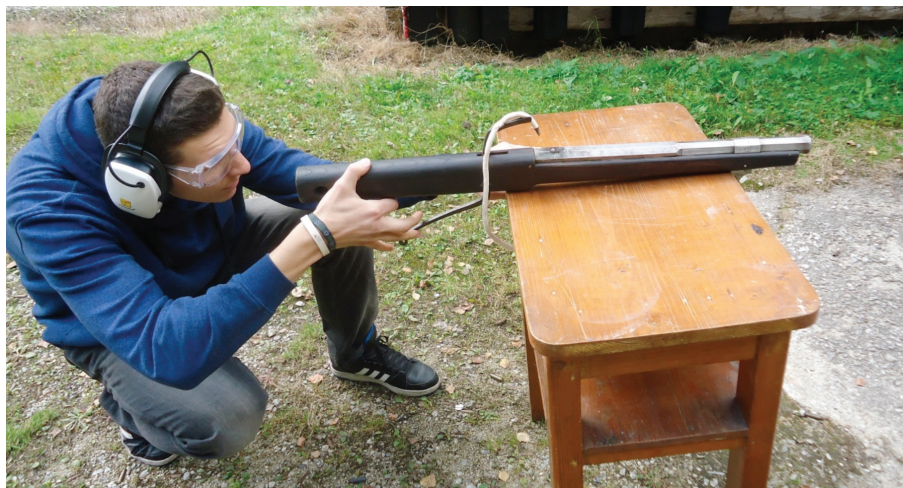
Obrázok č. 10. Mierenie na cieľ. Spätný ráz je minimalizovaný pomocou háku, umiestneného v spodnej časti hlavne. Fotografia: autor.
