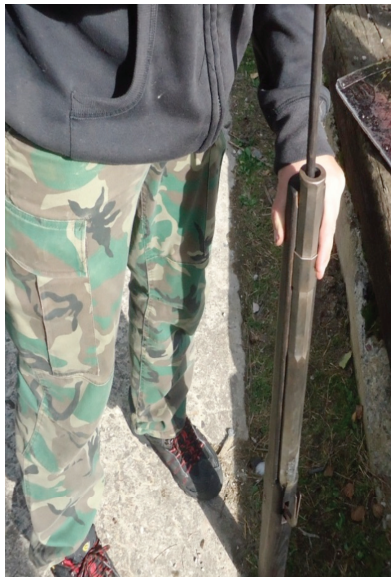
Obrázok č. 4. Systém nabíjania: Ubitie strelného prachu nabijakom, tento proces som opakoval aj po vložení projektilu a upchávky. Fotografia: autor.
