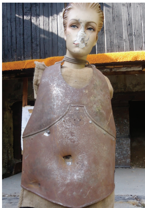
Obrázok č. 19. Strelba č. 22: projektil Figuríny IV. prestrelil kyrys (hrubý 1,5 mm) a prešívavý kabátec (hrubý 18 mm). Projektil sa zastavil až bôčiku na ktorom nechal silný otláčok. Fotografia: autor.
