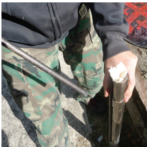
Obrázok č. 5. Systém nabíjania: Vloženie upchávky (ľanovej látky) do hlavne. Upchávku som vkladal aj po vložení projektilu do hlavne. Fotografia: autor.
