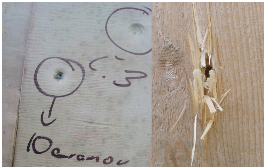
Obrázok č. 12. Porovnanie dvoch zásahov na Objekte B (celková hrúbka 31 mm, drevo 26 mm + hovädzia koža 5 mm). Streľba č. 6 (3 g) projektil sa odrazil verzus streľba č. 24 (10 g) úplný prestrel. Vpravo detail na miesto priestrelu. Fotografia: autor.
