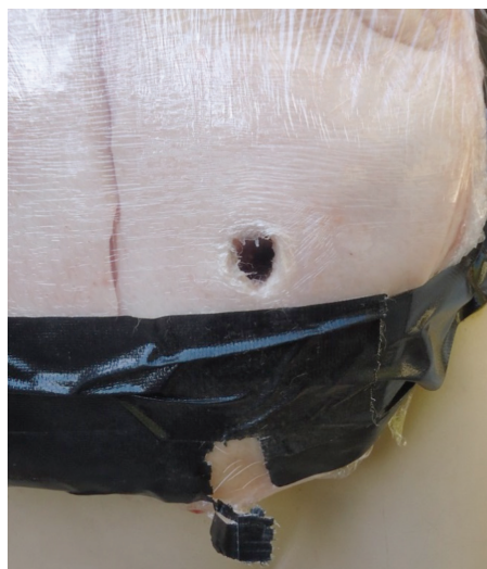
Obrázok č. 17. Strel'ba č. 20: projektil pri 7 g prestrelil prešívany kabátec (hrubý 18 mm), bravčový bôčik (hrubý 60 mm) a ďalej pokračoval v trajektórii za Figurínou III. Fotografia: autor.
