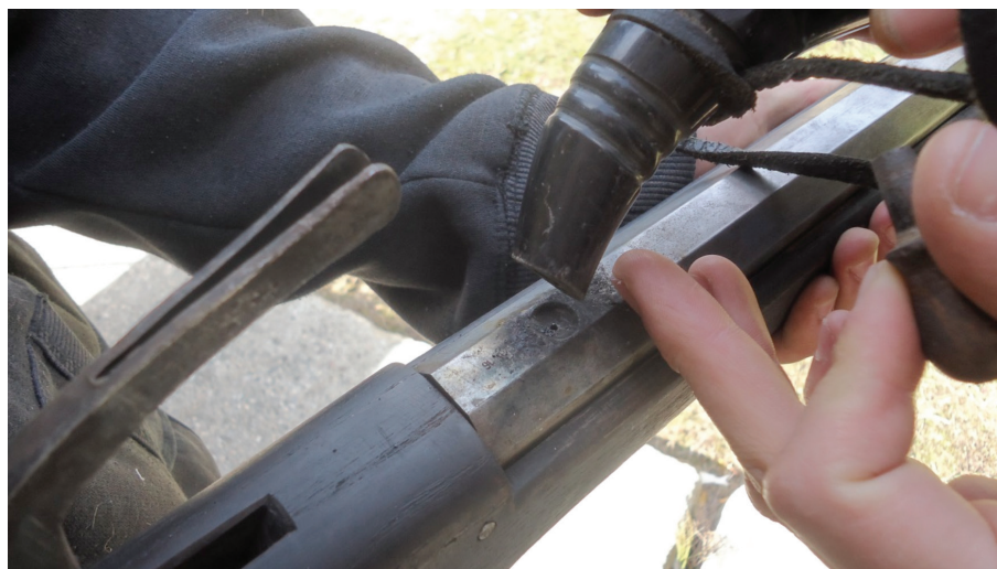
Obrázok č. 7. Systém nabíjania: Nasypenie jemného strelného prachu na panvičku. Fotografia: autor.
