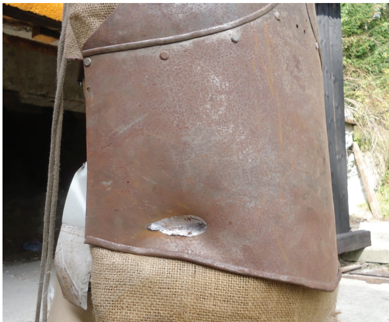
Obrázok č. 14. Strelba č. 16, detail po odraze projektilu od kyrysu pri 5,5 g strelného prachu. Fotografia: autor.
