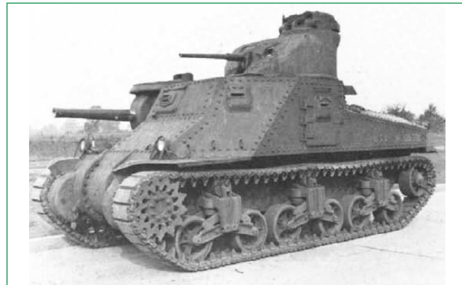
Príloha 27. Americký stredný tank M3 - v rámci britských jednotiek známy ako M3 Lee (zdroj: CHAMBERLAIN, Peter – ELLIS, Chris. Tanks of the World 1915 – 1945 . London : Cassell & Co., 2002, s. 174.)
