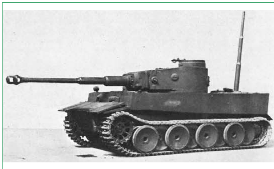
Príloha 30. PzKpfw VI Tiger I s vybavením pre prebrodenie vodného toku (zdroj: CHAMBERLAIN, Peter – ELLIS, Chris. Tanks of the World 1915 – 1945 . London : Cassell & Co., 2002, s. 59.)
