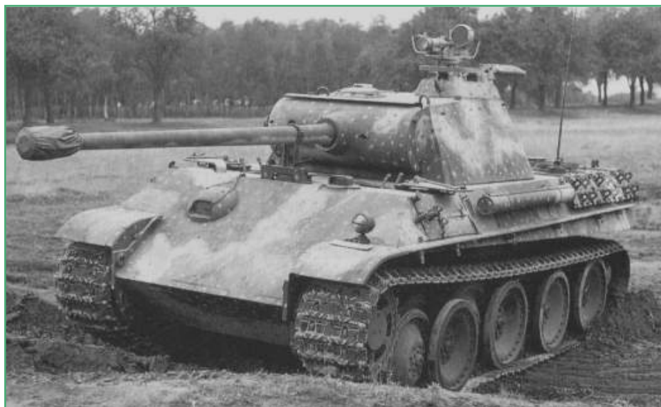
Príloha 29. PzKpfw V Panther Ausf. G – neskorá modifikácia vybavená zariadením na nočný boj (zdroj: http://www.panzernet.net/panzernet/stranky/tanky/pz5.php )
