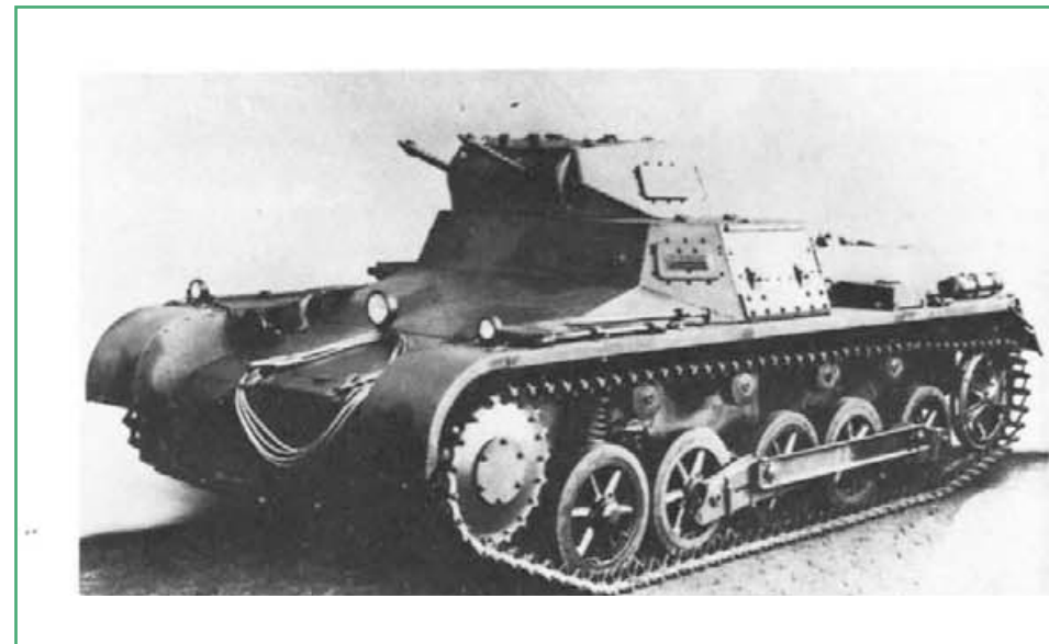
Príloha 3. PzKpfw I Ausf. B (zdroj: CHAMBERLAIN, Peter – ELLIS, Chris. Tanks of the World 1915 – 1945 . London : Cassell & Co., 2002, s. 48.)
