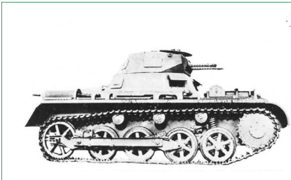
Príloha 2. PzKpfw I Ausf. A (zdroj: CHAMBERLAIN, Peter – ELLIS, Chris. Tanks of the World 1915 – 1945 . London : Cassell & Co., 2002, s. 48.)
