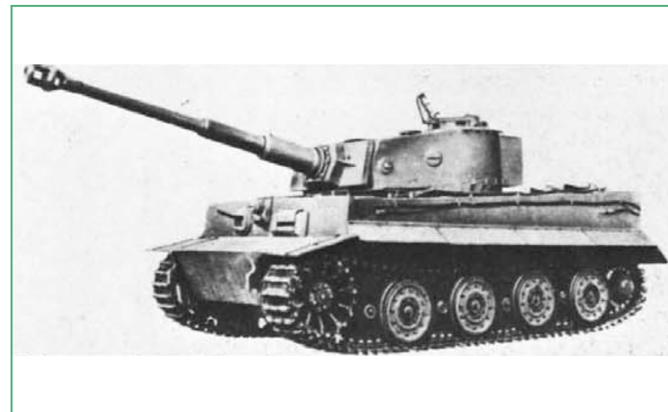
Príloha 31. PzKpfw VI Tiger I s celooceľovými pojazďovými kolesami bez gumového obloženia (zdroj: CHAMBERLAIN, Peter – ELLIS, Chris. Tanks of the World 1915 – 1945 . London : Cassell & Co., 2002, s. 59.)
