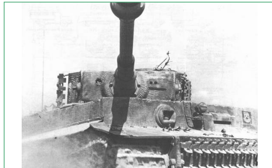
Príloha 28. PzKpfw Bližší pohľad na povrch tanku Tiger I pokrytý ochrannou pastou Zimmerit (zdroj: http://www.panzernet.net/panzernet/fotky/tanky/pz6/135.jpg )
